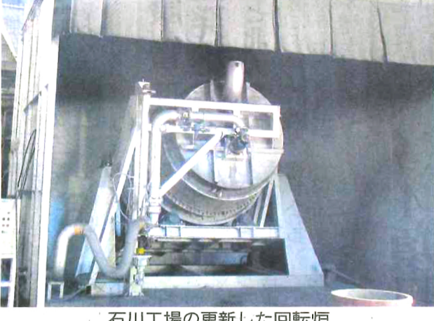
石川工場の更新した回転炉
